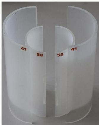
Figure 78 : Supports photocatalytiques REF exploités dans le photoréacteur
