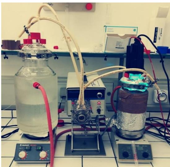
Figure 76 : Système expérimental pilote pour la réalisation des essais de photolyse/photocatalyse des pesticides
